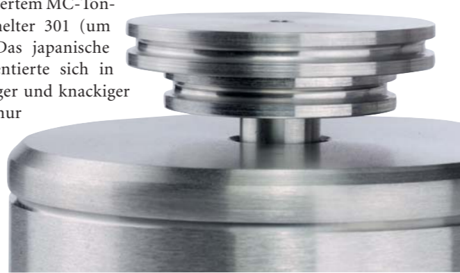
Der Motor läuft mit nur einer Drehzahl. Für den Wechsel von 33 auf 45 Umdrehungen wird der String auf die größere Pulley-Scheibe gelegt
