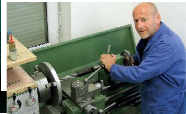
Eine typische Arbeit für Karl Wirth ist das Drehen der Abdeckung eines Motorgehäuses
