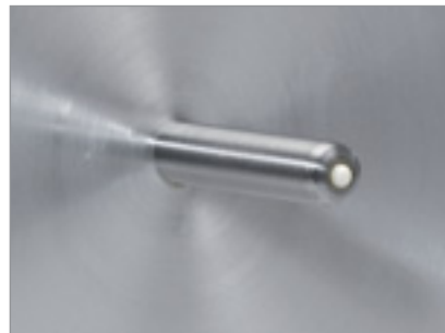
Achse und Lagerkugel unter dem mächtig schweren Teller. Mit Gefühl ins Lager setzen!
